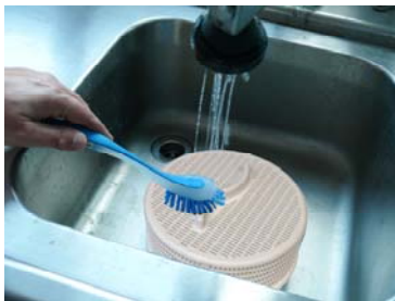
Nettoyez le filtre d'aspiration de la pompe à l'aide d'un pinceau.
