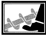
PELIGRO Evite las lesiones que puede causar la barrena rotatoria. Mantenga las manos, los pies y la ropa fuera de su alcance.
