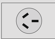
NEMA 10-50R Receptacle (solamente para US)
