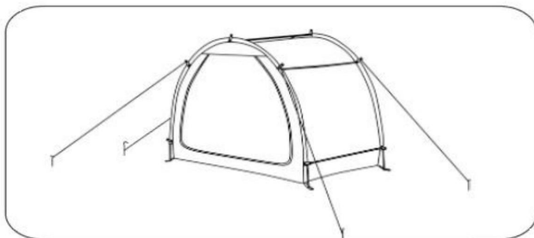
ÉTAPE 5 : Clou de sol fixe pour corde à vent
