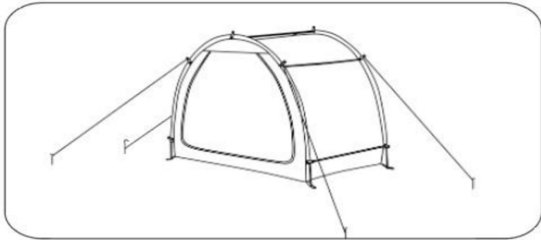
SCHRITT 5: Fester Windseil-Bodennagel
