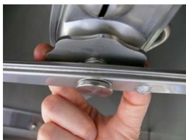
Dévissez le tourniquet de rinçage supérieur
