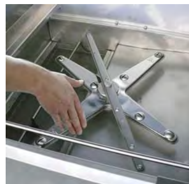
Vérifiez que le bras de lavage et rinçage soient libres de rouler (inférieurs et supérieurs)
