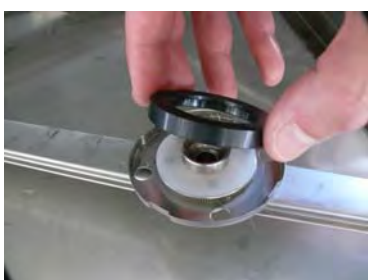
Inserez le bague noir cod.0201558 dans le tourniquet de rinçage supérieur
