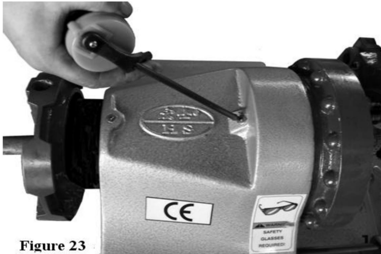
Figura 23. Ubicación de los puertos de aceite del cabezal
