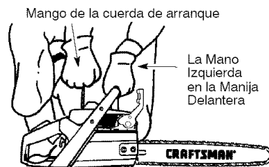
Mango de la cuerda de arranque El Pie Derecho en el Interior de la Manija Trasera.
