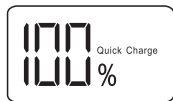
"Quick Charge" (Carga rápida) indica que el puerto USB-A está en uso
