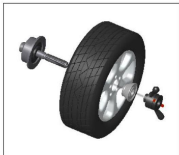
Albero principale-ruota— all'interno) cono adatto (testa piccola verso l'interno)—dado a maniglia rapida
