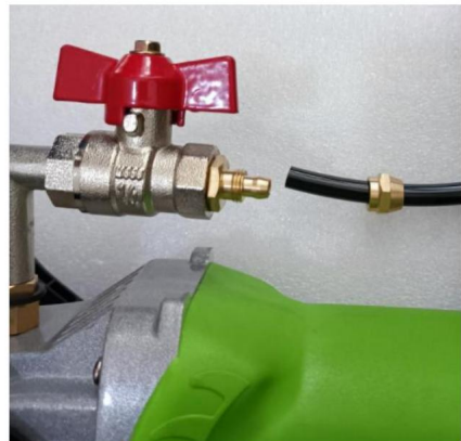
3. Installeer waterleidingverbindingen, vergrendel ze met een sleutel.
