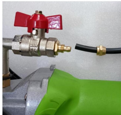
3. Wasserrohrverbindungen installieren und mit einem Schraubenschlüssel festziehen.
