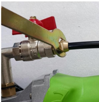
3. Wasserrohrverbindungen installieren und mit einem Schraubenschlüssel festziehen.
