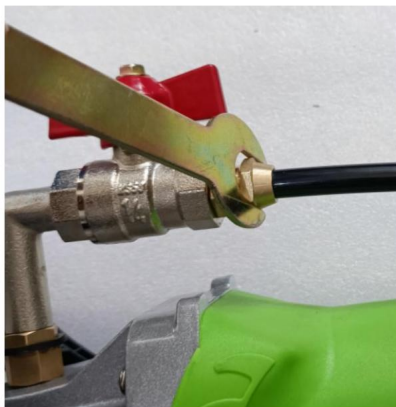
3. Installeer waterleidingverbindingen, vergrendel ze met een sleutel.
