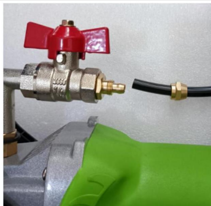
3. Installez les joints des conduites d'eau, verrouillez avec une clé.
