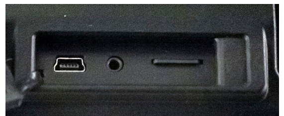
USB-Stromanschluss Videoausgang MicroSD-Kartensteckplatz
