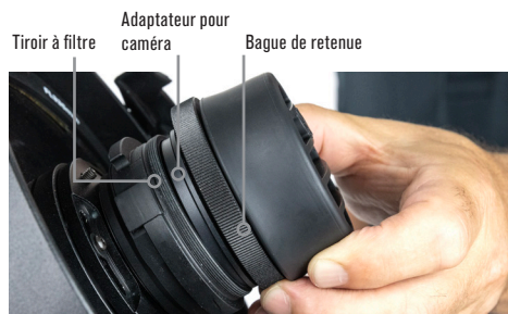
Fig. 8 : Placez l'adaptateur pour appareil photo sur le tiroir à filtre exposé, puis serrez la bague de retenue.
