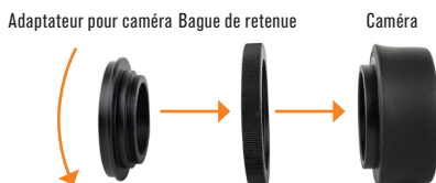
(Fig.7) L'adaptateur pour appareil photo passe par la bague de retenue et se visse sous l'appareil.
