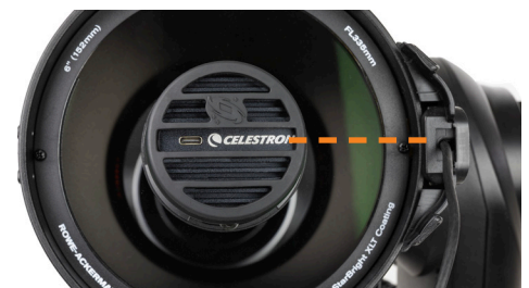
Fig. 9: Recomendamos orientar la cámara como se indica, con el sensor paralelo al logotipo Celestron de la parte anterior de la cámara. Esto posiciona el sensor perpendicular respecto al eje de altitud de Origin.
