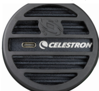
Abb. 6: Installieren Sie die Gummiabdeckung auf der Origin-678C Kamera, sodass sie wie abgebildet aussieht.
