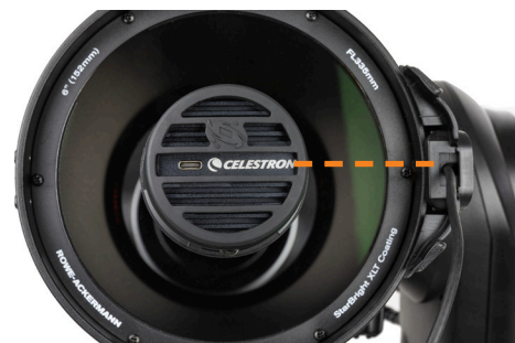
Abb. 9: Wir empfehlen, die Kamera wie abgebildet auszurichten, wobei der Sensor parallel zum Celestron-Logo auf der Vorderseite der Kamera ist. Dies positioniert den Sensor senkrecht zur Höhenachse von Origin.
