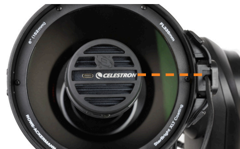
Fig. 9 : Nous vous recommandons d'orienter l'appareil photo comme illustré, avec le capteur parallèle au logo Celestron à l'avant. Le capteur est ainsi perpendiculaire à l'axe d'altitude de l'Origin.
