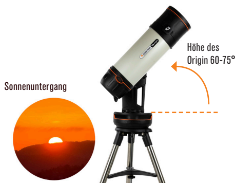
Abb. 10: Um einen „Sky Flat“ aufzunehmen, positionieren Sie Origin wie abgebildet etwa 20-30 Minuten nach Sonnenuntergang.
