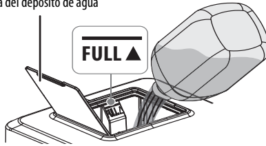
Tapa del depósito de agua
