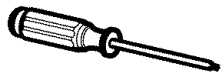
Tournevis à tête de force T 20 ou T 25, (nécessaire pour certains modèles)
