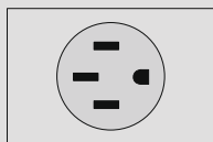
NEMA 14-50R Receptacle
