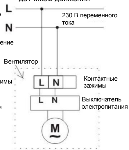
Схема электропроводки для вентилятора с датчиком движения
