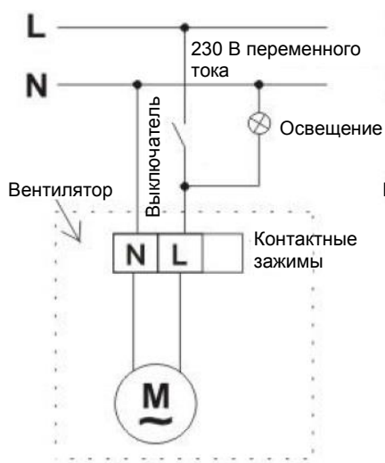
Схема электропроводки – Стандартные модели
