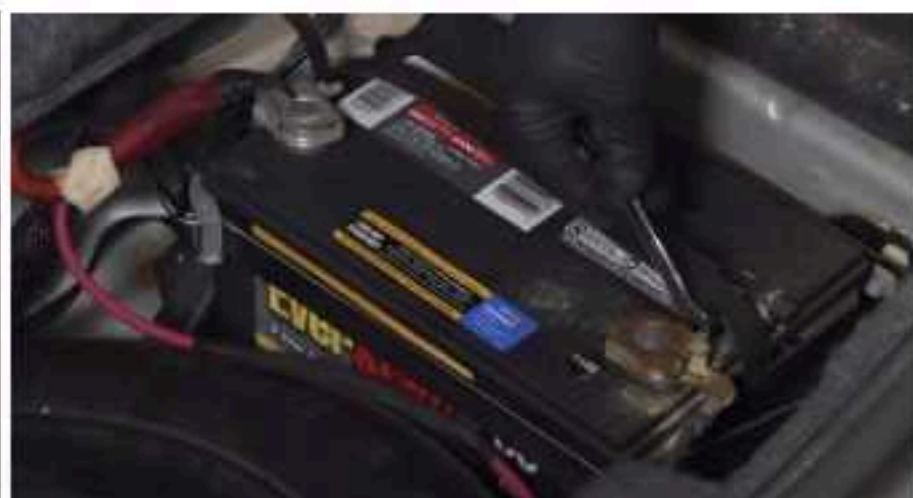
Desconecte la batería
