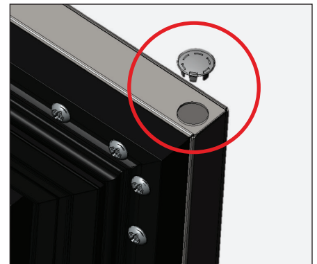
Fig. 11. Install the plug.
