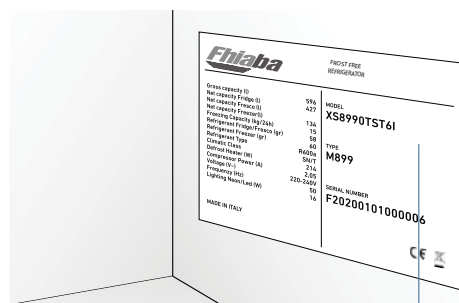
Posizione della targa matricola all'interno del vano.
