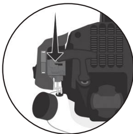
5. DÉPLACER L'ÉTRANGLEUR POUR PERMETTRE LE DÉMARRAGE En déplaçant le levier d'amorçage vers le bas à la position RUN.
