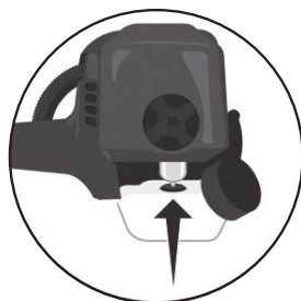
3. AMORCER LE MOTEUR 7 FOIS En appuyant sur la poire d'amorçage à côté du capuchon de réservoir à essence.
