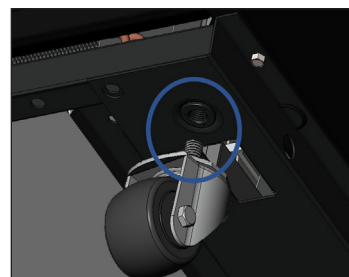
Fig. 6. Loosen castor bolt.
