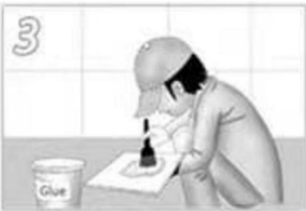
Stap 3: Breng lijm aan op het paneel rug.
