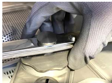
Agir sur le „grande“ écroue pour dévissier le bras de rinçage.
