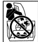
PELIGRO Pare el motor antes de desatascar el tubo de descarga.
