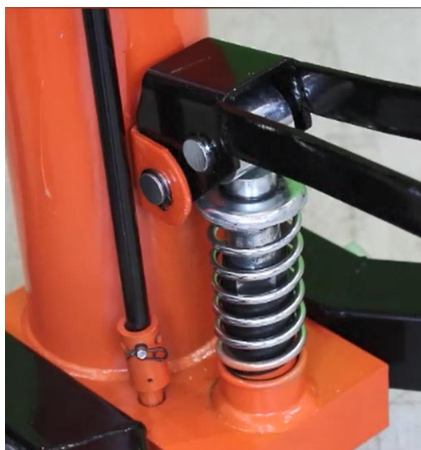
Fase 5: Installare le viti dell'anello della maniglia .
