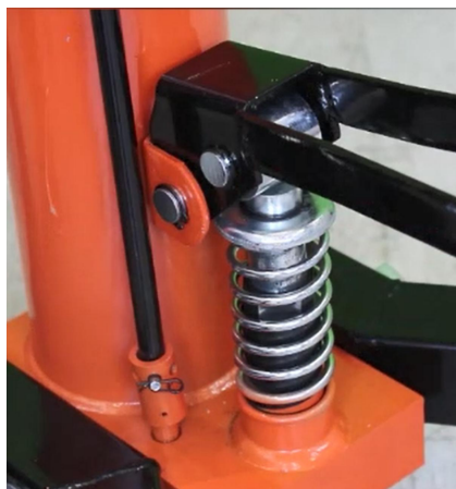
Schritt 5: Griffingschrauben anbringen .
