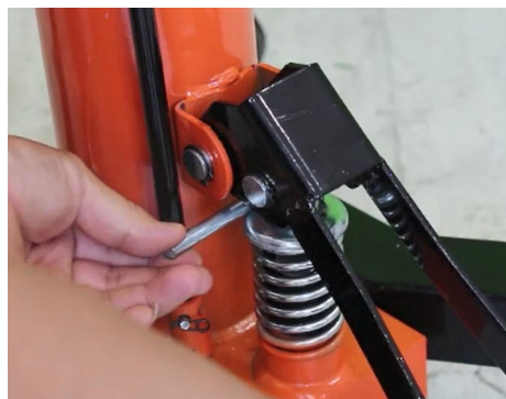
Fase 4: Intrappolare la maniglia sopra il cilindro .
