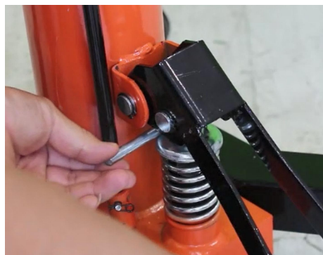
Schritt 4: Stecken Sie den Griff über den Zylinder .
