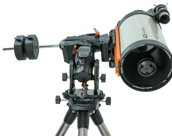
Figura 9.2 Un lato del limite meccanico di DEC
