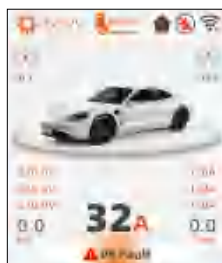
Missing of PE Protection
