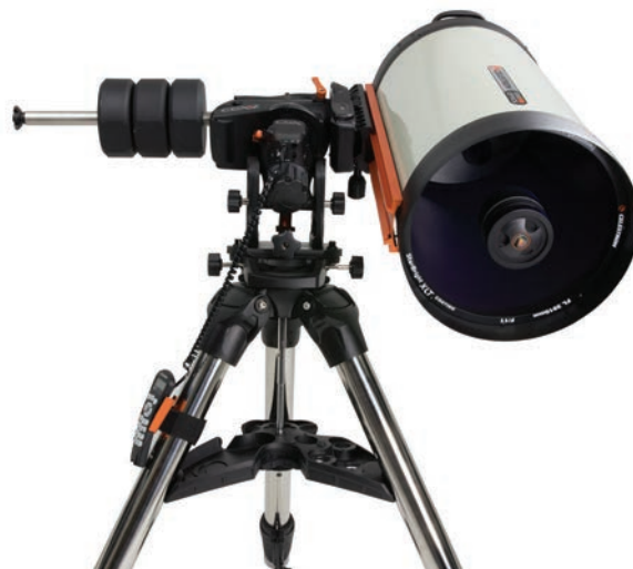
Figura 6 Bilanciare la montatura
