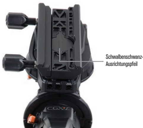
Abbildung 4 Die Montierung am Stativ befestigen
