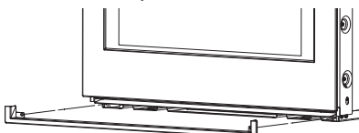
1. Installation affleurante de la garniture inférieure
