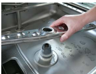
Enlevez les tourniquets de rinçage et lavage inférieur
