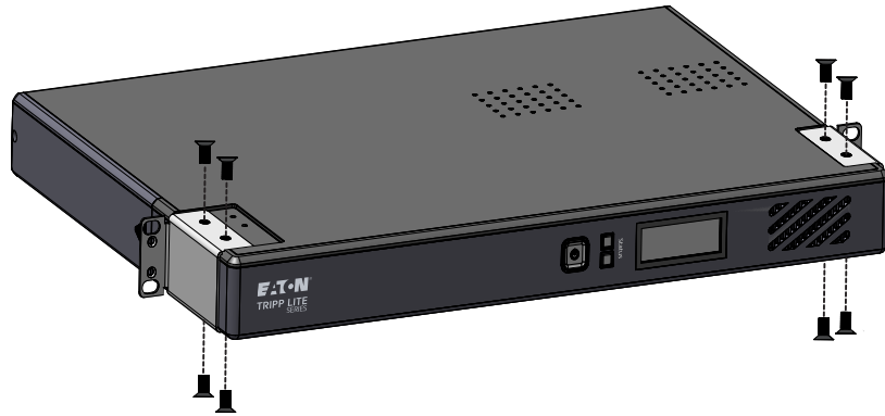
Figure 8. Instalación en soporte de dos postes
