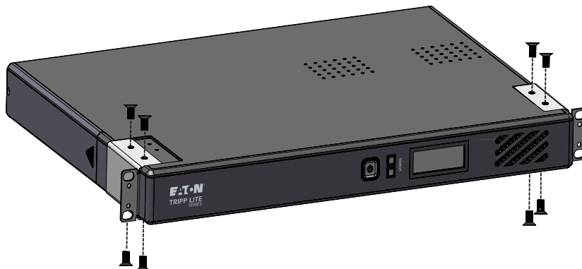
Figure 7. Instalación en soporte de cuatro postes
