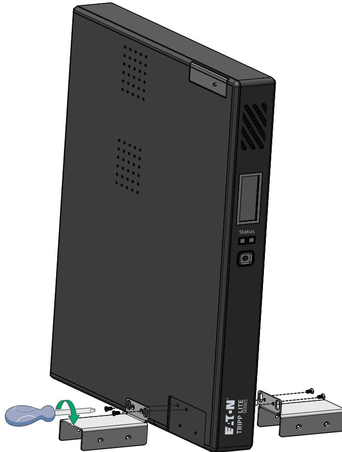
Figure 5. Montage en position tour
