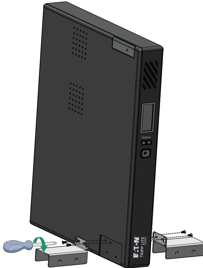
Figure 5. Montaje en torre
