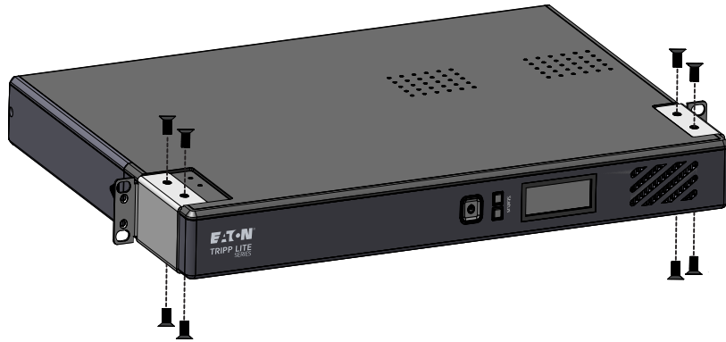
Figure 8. Instalación en soporte de dos postes
