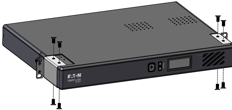
Figure 8. Installation sur bâti à deux montants
