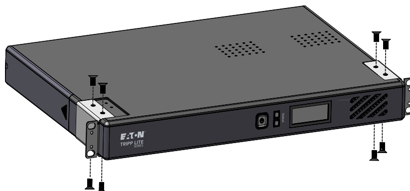
Figure 7. Installation sur bâti à quatre montants
