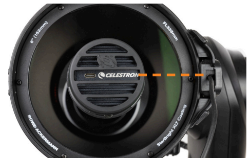
Abb. 9: Wir empfehlen, die Kamera wie abgebildet auszurichten, wobei der Sensor parallel zum Celestron-Logo auf der Vorderseite der Kamera ist. Dies positioniert den Sensor senkrecht zur Höhenachse von Origin.
