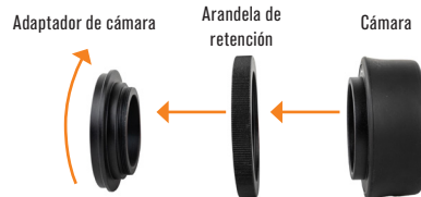
Fig. 4: Retire el adaptador de cámara y la arandela de retención de la cámara desenroscando el adaptador de la cámara.
