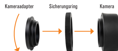
Abb. 7: Der Kameraadapter geht durch den Sicherungsring und wird in die Unterseite der Kamera geschraubt.
