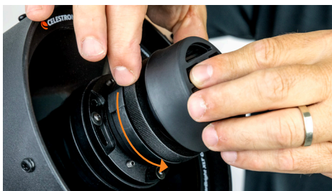
Abb. 2: Um die Origin-178C Kamera von Origin zu entfernen, schrauben Sie zuerst den Sicherungsring ab.
