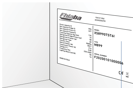
Posizione della targa matricola all'interno del vano.
