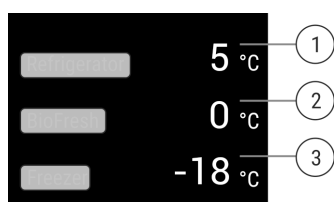
Fig. 9 The status display shows the actual temperature.*
