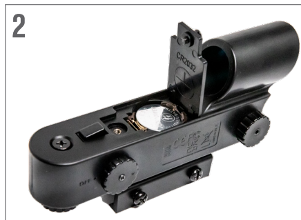
2. Se si sta sostituendo la batteria, installare la nuova con il polo (+) rivolto verso l'esterno.
