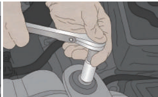
Afloje los pernos de montaje
