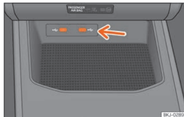
Fig. 128 Centre console: USB input.
