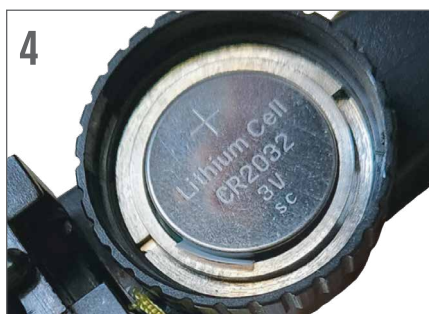
4. Sistemare nuovamente la batteria nell'apposito vano con il polo positivo (+) rivolto verso l'alto.
