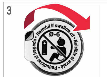
3. Décollez l'autocollant bloquant le circuit de la pile CR2032.
