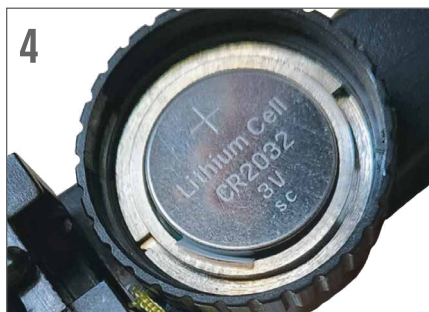
4. Placez la pile dans le compartiment à pile, le côté (+) orienté vers le haut.
