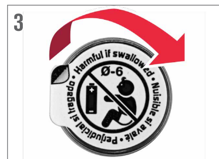
3. Tirare la linguetta che blocca il circuito della batteria CR2032.
