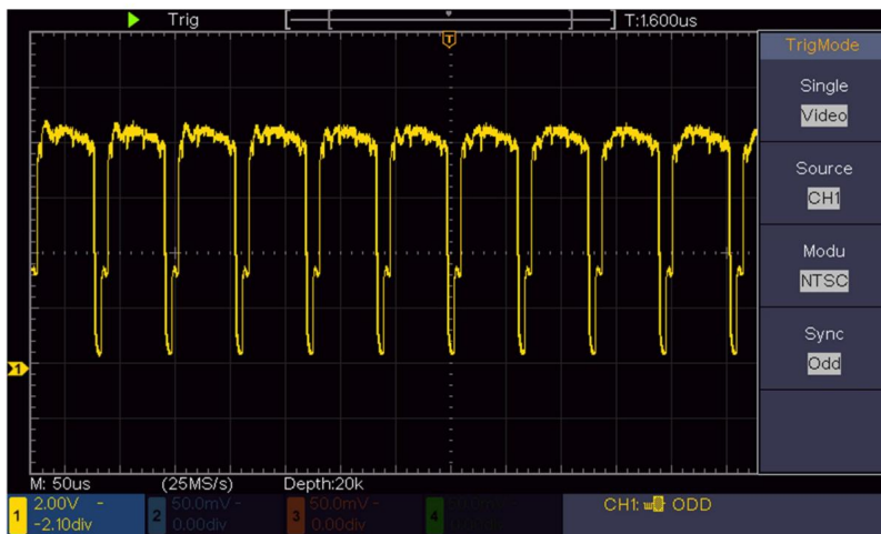
Abbildung 6- 7 Vom Video Field Trigger erfasste Wellenform
