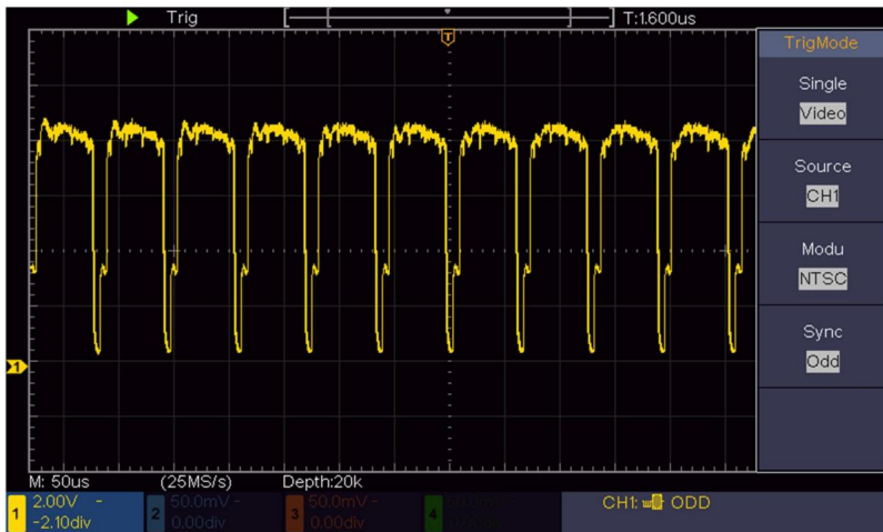
Figuur 6-7 Golfvorm vastgelegd van Video Field Trigger
