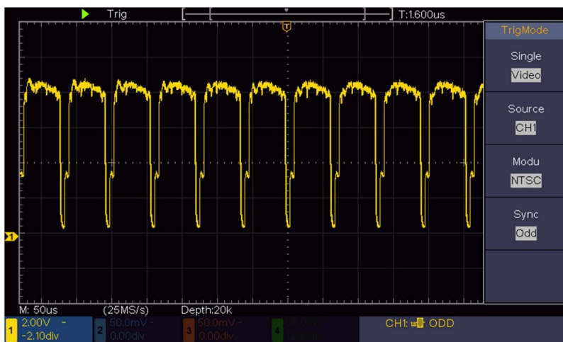
Figura 6-7 Forma de onda capturada del disparador de campo de vídeo
