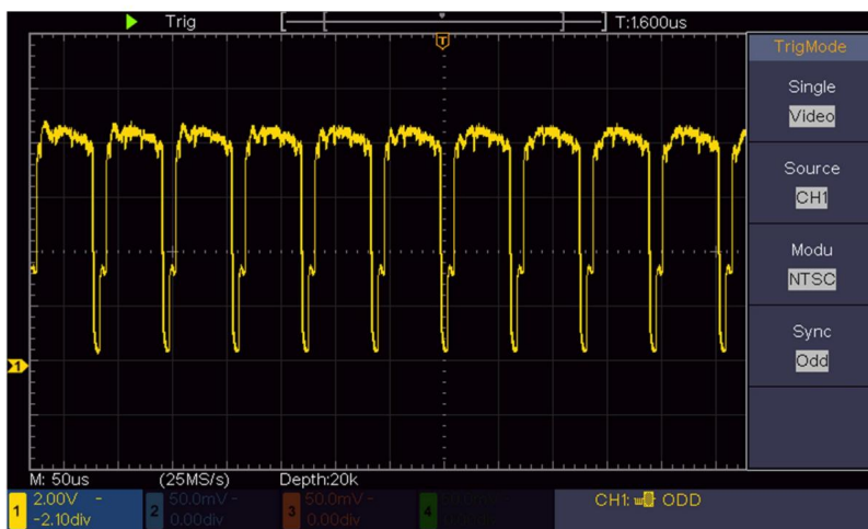
Figur 6- 7 Vågform infångad från videofälttrigger
