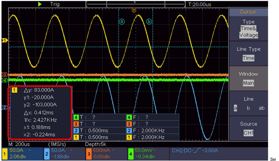
Abbildung 4- 15 Zeit- und Spannungsmessung mit dem Cursor
