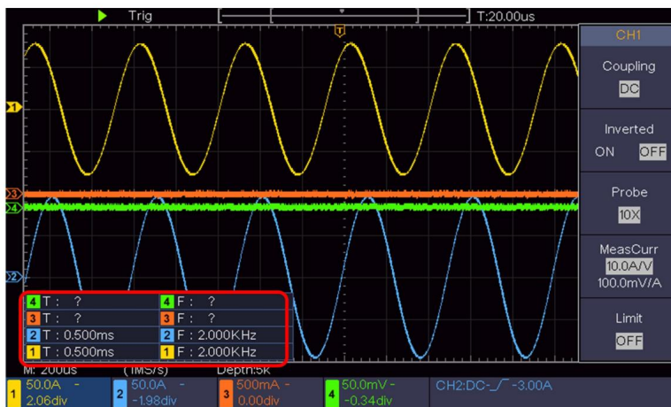
Figure 6- 1 Mesure de la période et de la valeur de fréquence pour un signal donné
