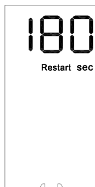
Состояние защиты компрессора
