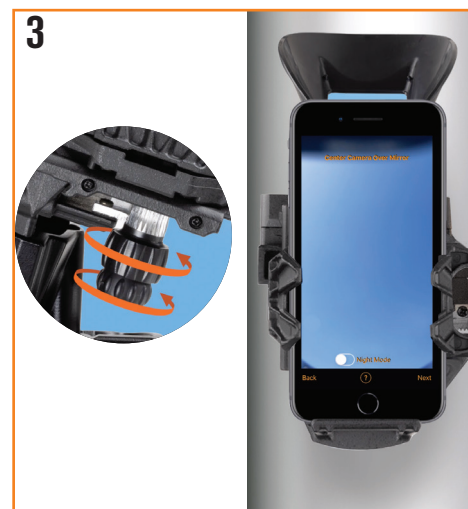
3. Ensuite, vous allez centrer votre téléphone sur le miroir du StarSense Dock. Faites tourner les molettes sur le bas du support jusqu'à ce que la vue de votre caméra soit centrée et complète dans le miroir.
