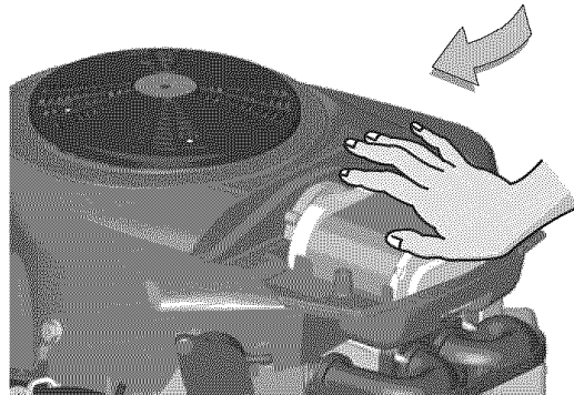
Figura 30. Instalación del filtro de aire A. Cartucho del filtro
