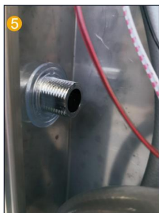
5 Insérez la buse de pulvérisation manuelle dans le panneau et installez le joint.
