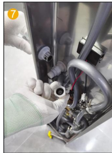
7 Setzen Sie den 4-Wege-Gummi in den Anschluss des Handbrause.
