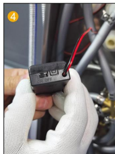
4 Changer le boîtier de la batterie à ON.
