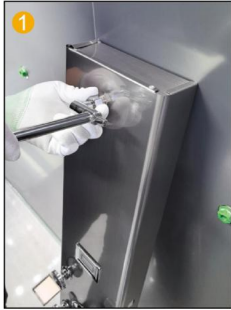
1 Befestigen Sie den Wasserauslassarm zur Hauptplatte.
