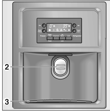
2 Mando contacto para la extracción de agua o hielo 3 Bandeja colectora del agua
