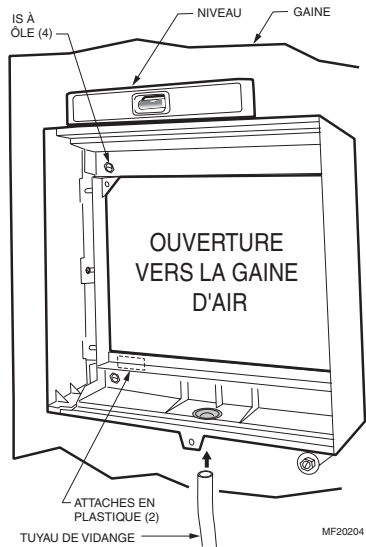
Fig. 5. Installation de l'humidificateur sur une gaine.
