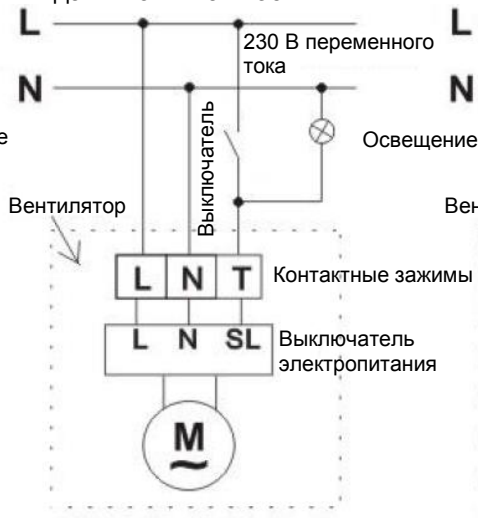
Схема электропроводки для вентилятора – модели с таймером / датчиком влажности
