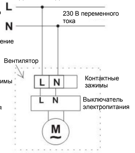
Схема электропроводки для вентилятора с датчиком движения
