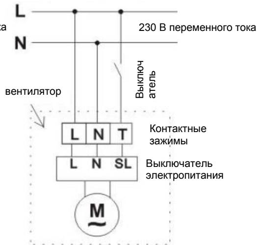
Схема электропроводки для вентилятора – модели с таймером / датчиком влажности
