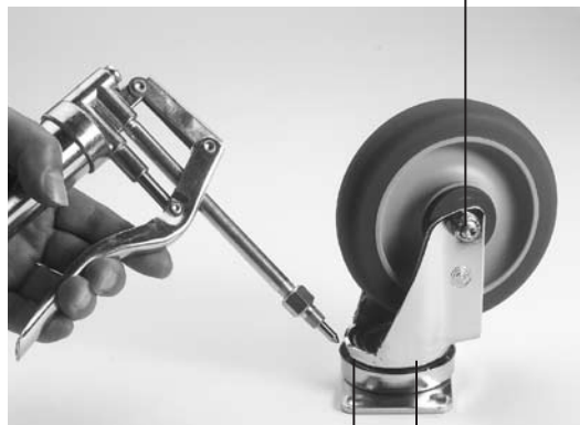
Fig. 1 Superficie di rotolamento delle ruote girevoli
