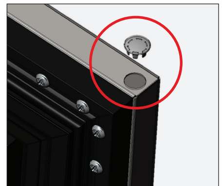
Fig. 11. Install the plug.
